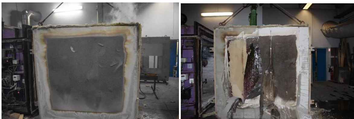
Figur 14: Prøveemne B (tv. prøveemne efter brandtest (eksponeret side), th. Prøveemne B efter afkøling med vand og delvist adskilt for at besigtige beskadigelse).
