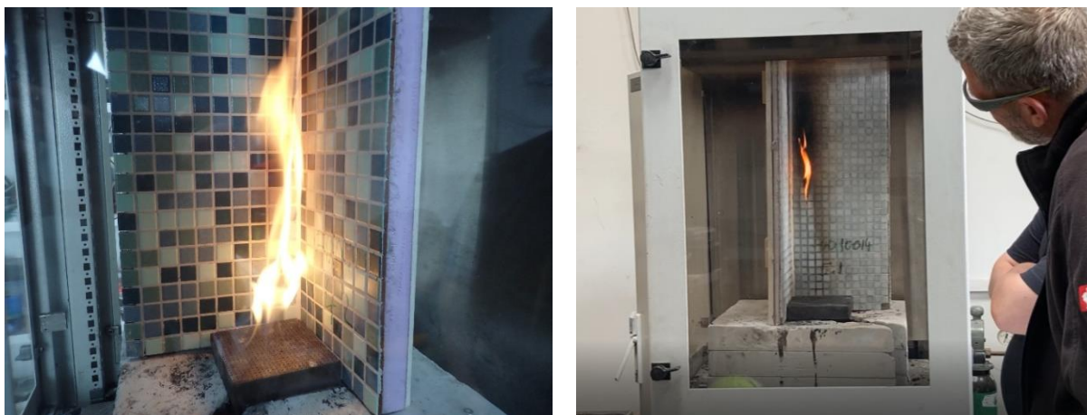
Figur 4: Forsøgssopstilling ved mini SBI test (tv. keramisk mosaik – th. flammedannelse fra glas mosaik efter brænderen er slukket)
