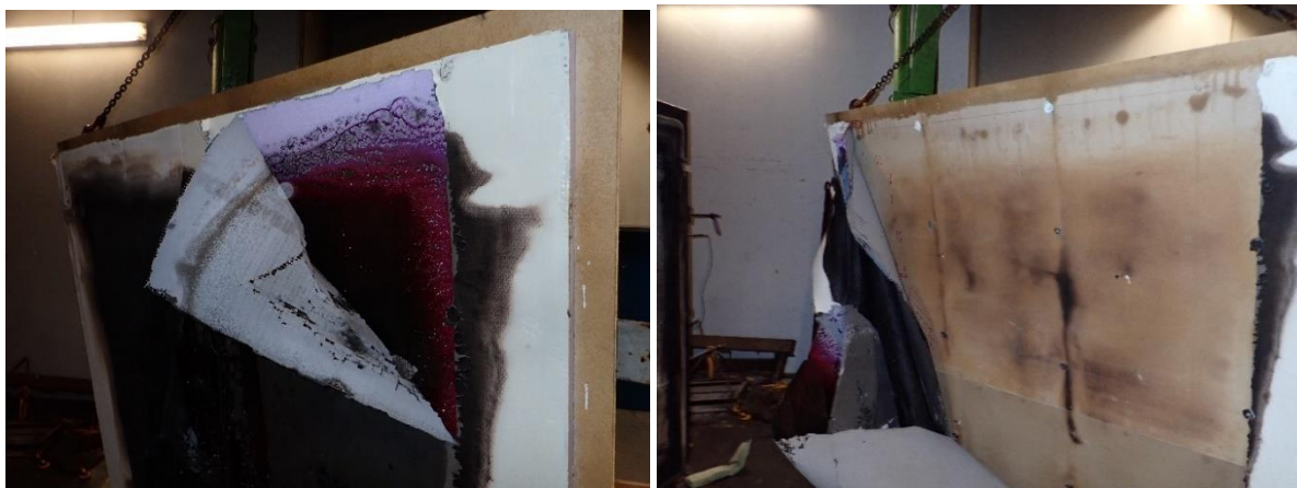
Figur 17: Prøveemne C efter test (tv. vådrumsplade bag ved det brandbeskyttende lag, th. påvirkning af underlag/substrat, hvorpå prøveemne har været monteret – der ses "spor" på spånpladen).
