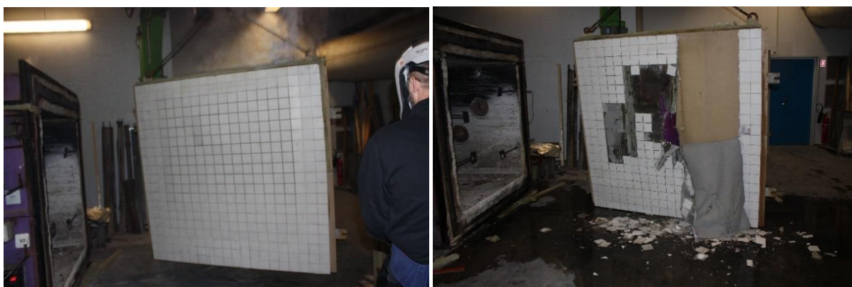
Figur 12: Prøveemne A (tv. prøveemne efter brandtest (eksponeret side), th. Prøveemne A efter afkøling med vand og delvist adskilt for at besigtige beskadigelse.)
