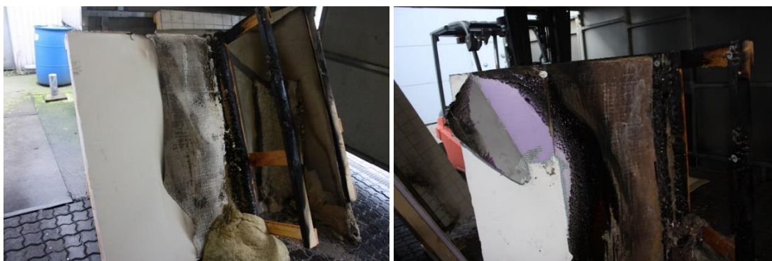
Figur 10: Prøveemne C (tv. prøveemne efter brandtest, th. ikke-brandskadet vådrumsplade i venstre del af prøveemne)
