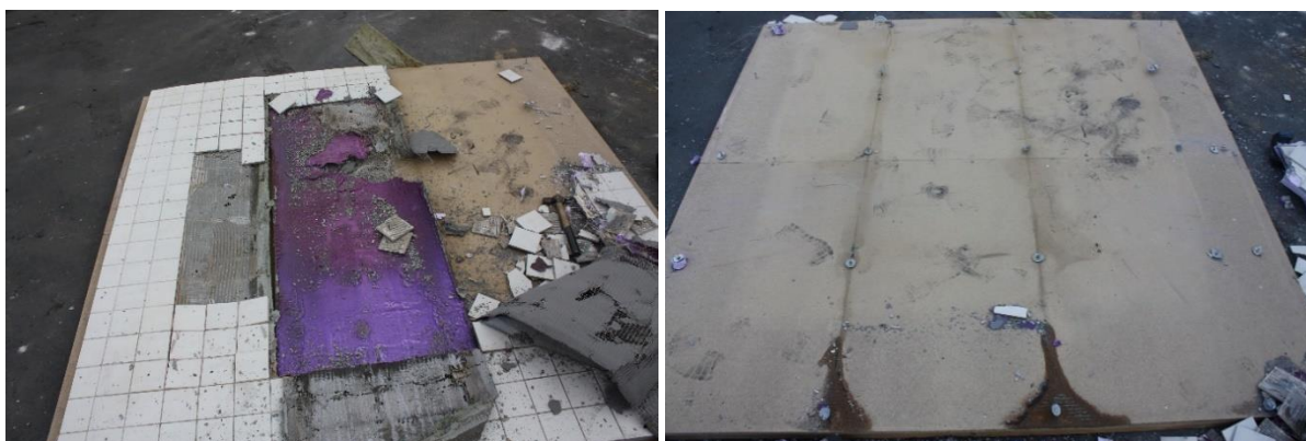
Figur 13: Prøveemne A efter test (tv. under adskillelse, th. spånplader, hvorpå prøveemne var monteret – der ses aftegninger ved pladesamlinger).
