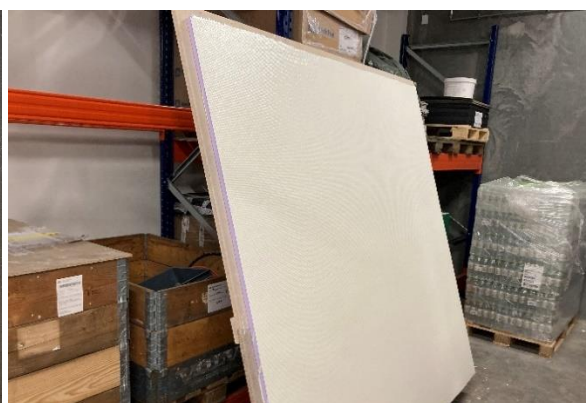
Prøveemne C under tørring (konditionering)
