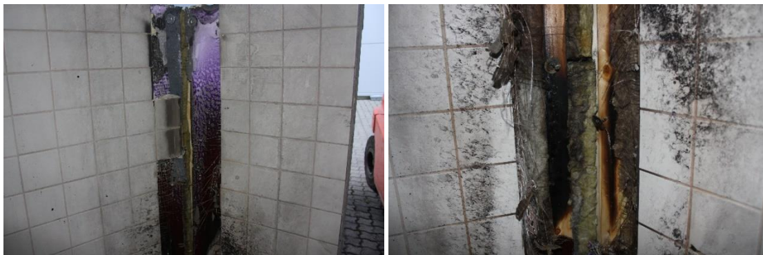
Figur 8: Prøveemne A (tv. prøveemne efter brandtest, th. skader på træreglar/substrate)
