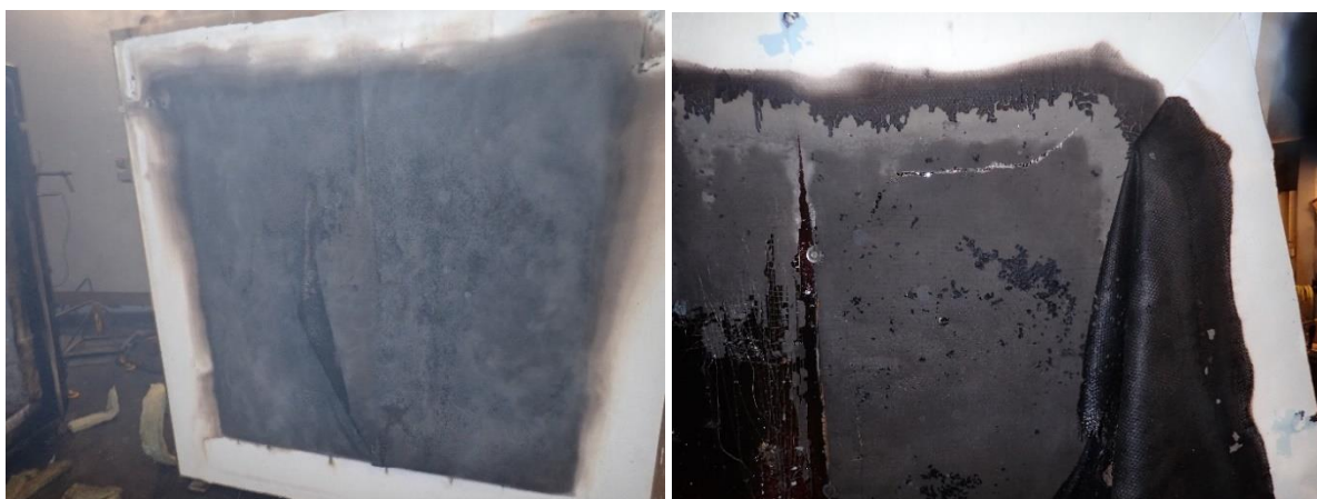
Figur 16: Prøveemne C (tv. prøveemne efter brandtest (eksponeret side), th. ydersiden af vådrumspladen efter delvis fjernelse af glasvæv fra "vådrumssystemet/malersystemet").
