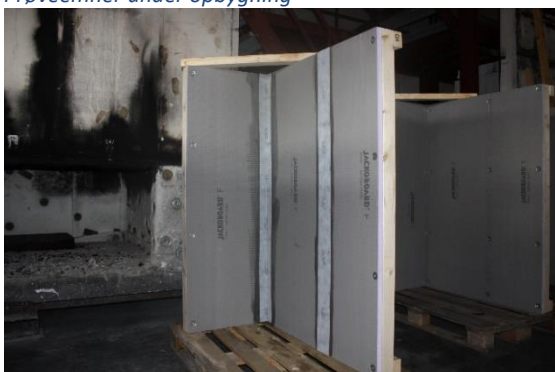
Armering påført samlinger (prøveemne A)
