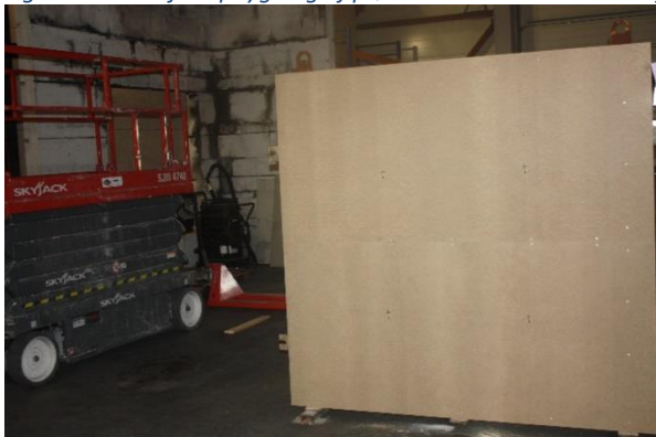
"Bagplade" af spånplade, hvorpå prøvemener monteres
